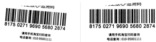
(a) 霍夫变换前图像 (b) 霍夫变换后校正图像
